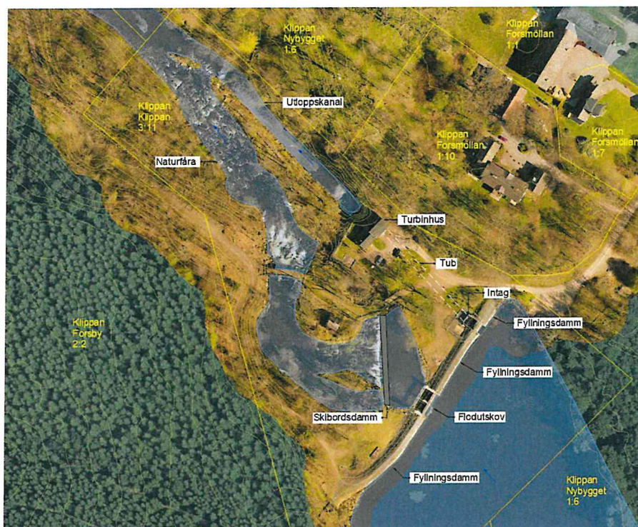
Figur 2. Översiktsbild med anläggningsdelar.
